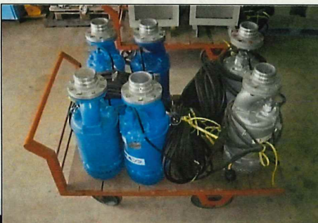
災害応急用ポンプ(水中)
