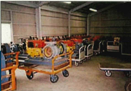
災害応急用ポンプ(陸上)
